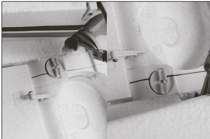
Führen Sie die Klappen-Schubstange durch den Schraubenverschluss zum Servohebel. Anschließend nehmen Sie die Querruderservokabel und verbinden sie mit den Servoverlängerungskabeln. Verbinden Sie die Tragflächenlichter mit der Lichteinheit. Achten Sie dabei auf die Polarität.
